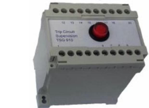
Das optische Signalelement S liegt über einem Schliesskontakt von Relais C an der Alarmspannung. Seine optische Anzeige kann jetzt durch Drücken von Hand gelöscht werden. Die Wicklung 3-2 des Messrelais AB ermittelt jede Störung im Auslöse-Stromkreis. Dabei fällt es ab. Mit der Verzögerung von >400msek fällt auch das Relais C ab, wodurch Alarm und optische Anzeige ausgelöst werden.
